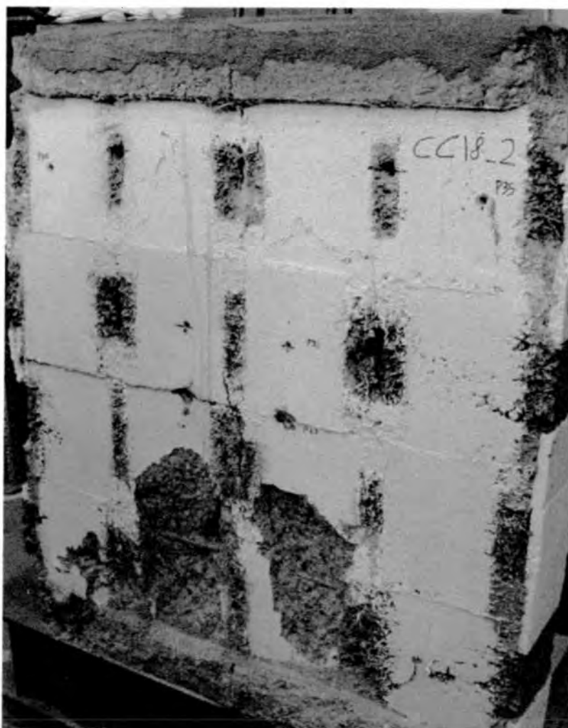
Figura 17. Pannello CC18_02: Quadro fessurativo al termine della prova di compressione centrata.
