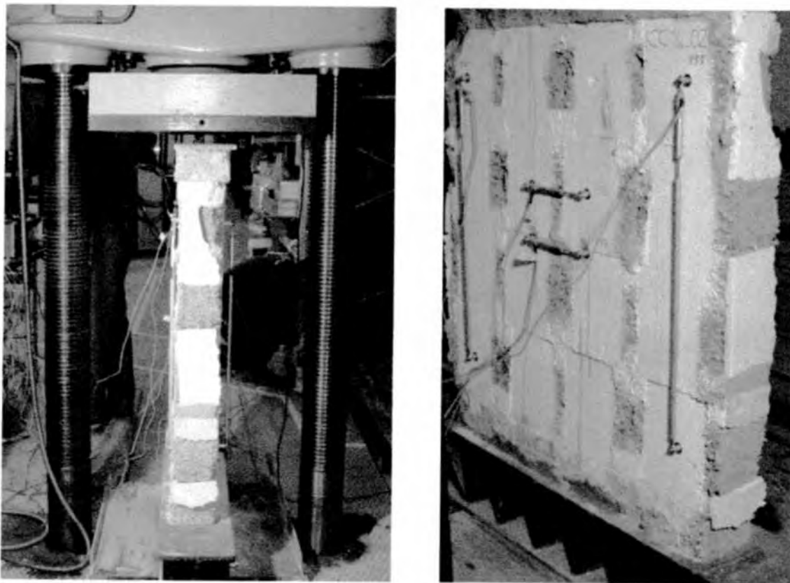
Figura 15. Pannello CC14_02: Il pannello prima della prova a compressione centrata.
