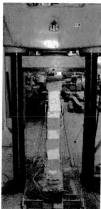
Figura 5. Set-up delle prove di compressione centrata.
