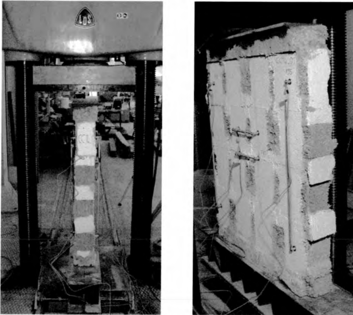
Figura 13. Pannello CC14_01: Il pannello prima della prova a compressione centrata.
