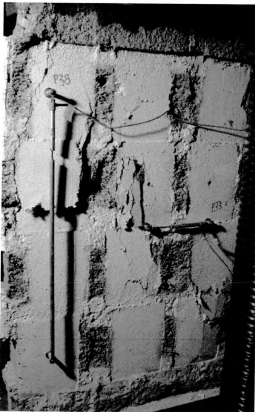
Figura 14. Pannello CC14_01: Il pannello al termine della prova di compressione centrata.
