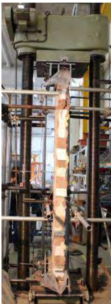
Figura 5. Set-up della prova con indicazione della posizione degli strumenti.
